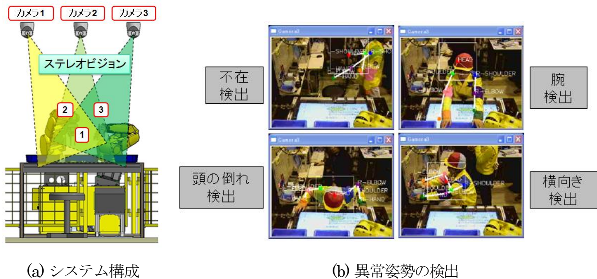
図29 作業員位置姿勢測定システム
