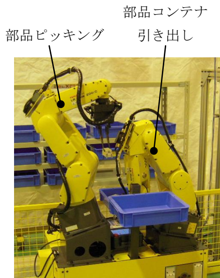
図 20 双腕ロボットアームによる部品ピッキング
