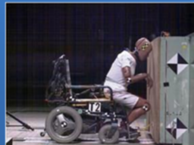
ダミーを用いた衝突安全性評価試験
