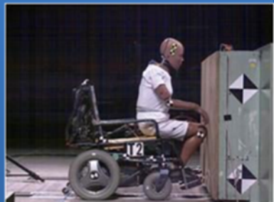
ダミーを用いた衝突安全性評価試験
