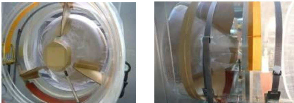
図 2. 1. 3. 1-33 捕集部下流側に取り付け風速変化治具例
