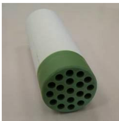
図 2.3.2-3 ガラスによる多チャンネル型多孔質基材末端部分のシール
