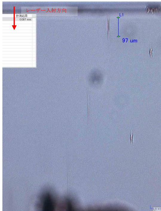
図 KF16 40x (0.55) レンズを併用したホログラム (4 段型) 加工による異質相の光学顕微鏡画像。パルス幅 : 570fs (AC)、平均出力 : 400mW、照射時間 : 10sec
