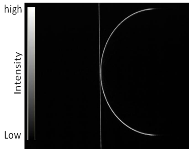
図(2)(b)-9 作製した位相4段ホログラムのHe-Neレーザーによる再生像
