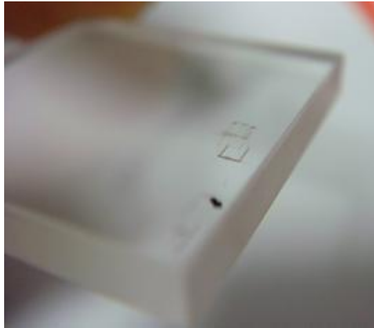
圖 3-1-2-(2)-(c)-8: 立方体粹型加工結果
