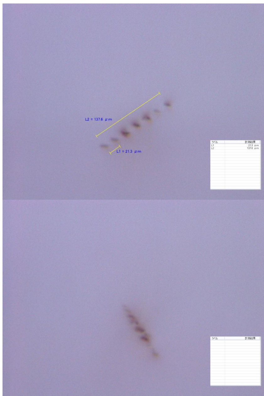
図 3-1-2-(2)-(c)-35: 7×2ドット加工結果(上: 第1面、下: 第2面)
