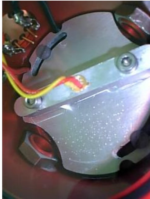
図 3-1-2-(2)-(c)-7: Ti:S チャンバー内の結露状況
