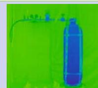
輻射熱による安全弁作動試験 水素放出時の附属品類の温度
