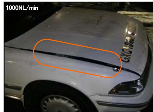
引火後の車両の損傷程度
