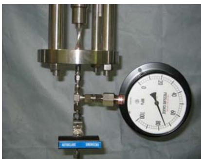
SUS316Lの最も水素環境脆化の大きい低温(190K)含む、極低温・高圧の水素ガス中における引張・疲労特性評価法を確立
