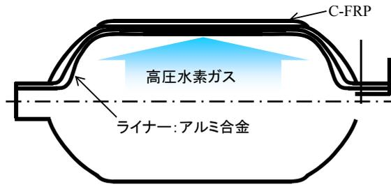
図1 VH3型高圧水素容器の構造
