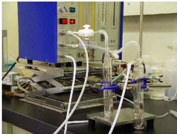
図Ⅲ 2.2.2.1-4 パーミエーターにより調製された定常濃度ギ酸ガスのインピンジャーによる捕集
