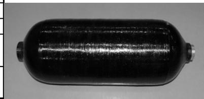
圧力サイクル試験は、環境温度と上限圧力をパラメータとし、低温条件 (LT:-40°C、28 MPa)、室温条件 (RT:15°C、35 MPa) および高温条件 (HT:85°C、44 MPa) の SOC100%を想定した3条件と、JARI S 001 の常温圧力サイクル試験で規程されている条件 (NT: Normal temp. (15~35°C、温度制御なし)、44 MPa) について、各条件容器2本ずつ実施した。
