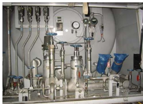
図III 2.3(2)10-2 上から、解体調査に供した液体水素ローリー（15ton トラック）、ステンレス鋼製内容器、台車後部の付属部品
