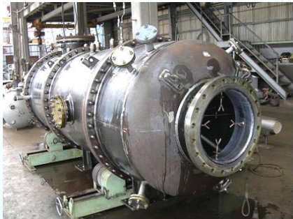
製作中の改質炉(外径φ1200mm×長さ4050mm)
