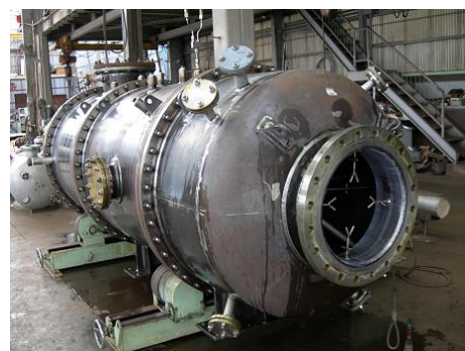
図Ⅲ-8 製作中の改質炉外観
