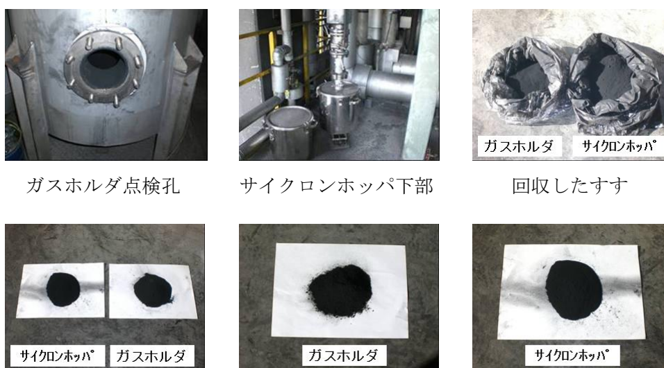
図Ⅲ-32 改質試験後のすすの採取状況
