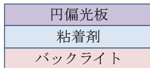
図 2.5.2.2.3-2 バックライト高度集積部材の層構成図
