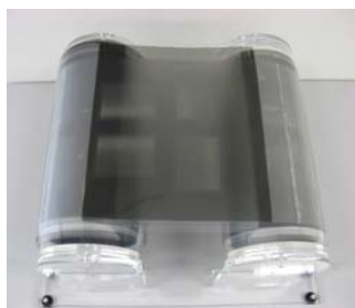
写真 2.5.2.2.3-2 貼合方式円偏光板集積バックライト部材の外観写真
