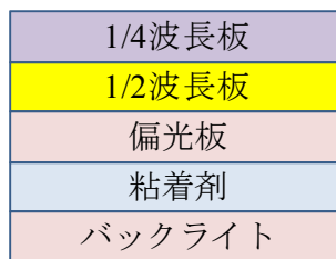
図 2.5.2.2.3-4 バックライト高度集積部材（塗布方式）の層構成図
