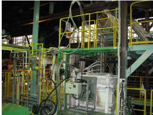
図Ⅲ-2-A3-2. 改造後のインフライトメルティング試験炉
