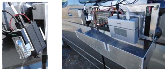
図Ⅲ.2-53 車載投光式高速ビジョンセンサ
