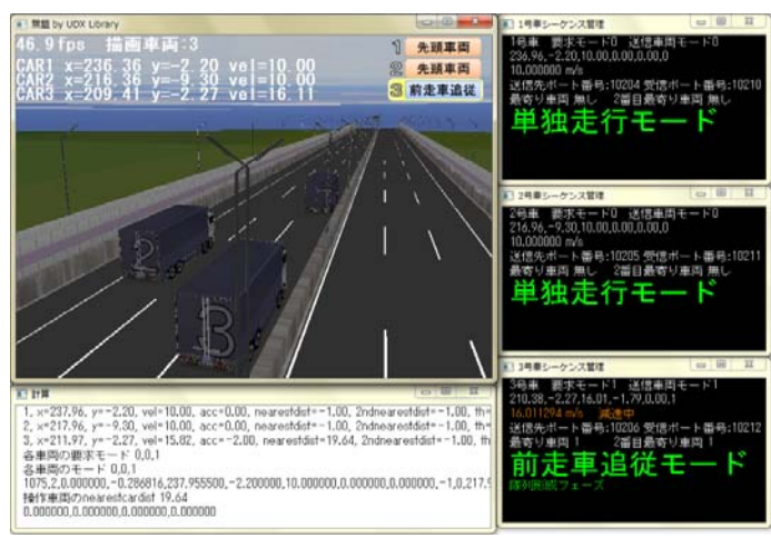
図Ⅲ.2-31 隊列形成制御シーケンス評価用シミュレータ
