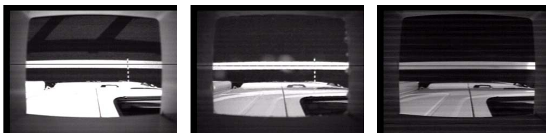
図Ⅲ.2-42 白線認識結果 (左：影、中央：雨、右：トンネル内 (25%照明))
