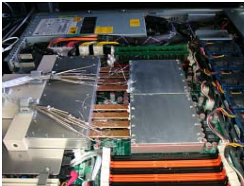
図 4-6 ヒートパイプによる CPU 冷却
