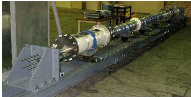
図 2.2.1-40 三心コア引張試験装置の概観写真
