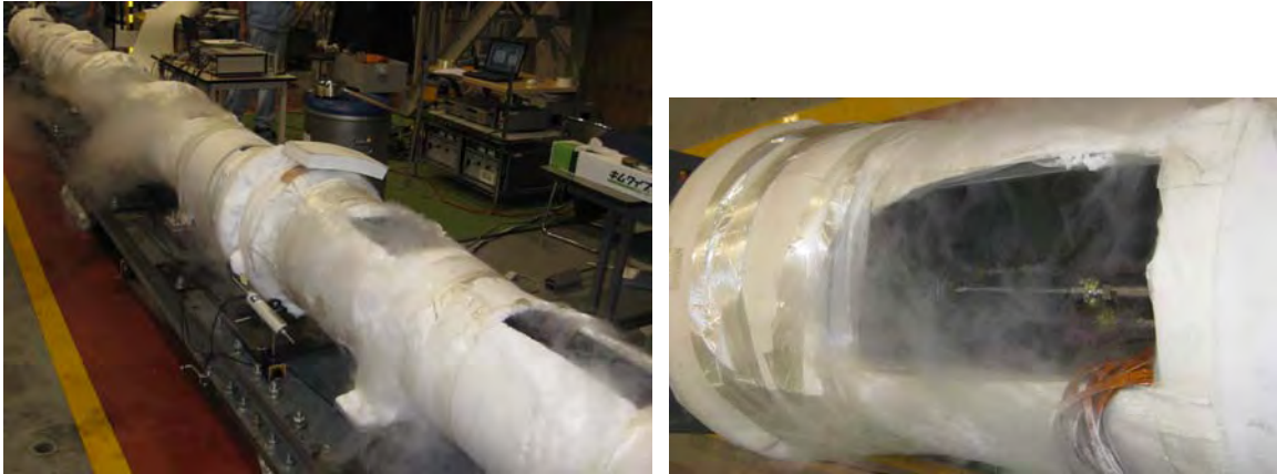
図 2.2.1-41 三心コアサンプルの LN 2 中での引張試験状況
