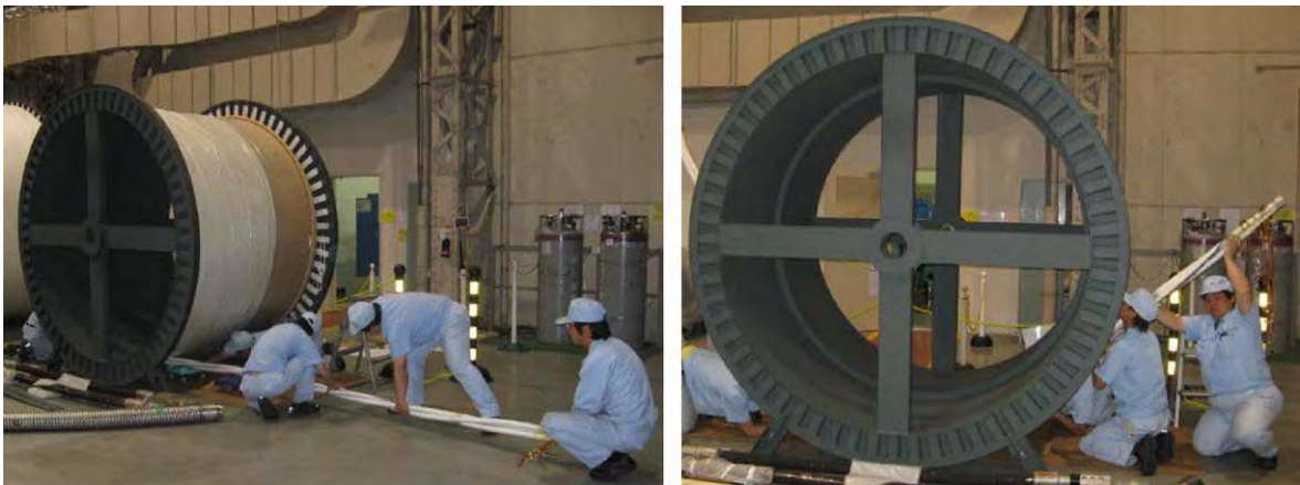
図 2.2.1-38 三心ケーブルコアの曲げ試験
