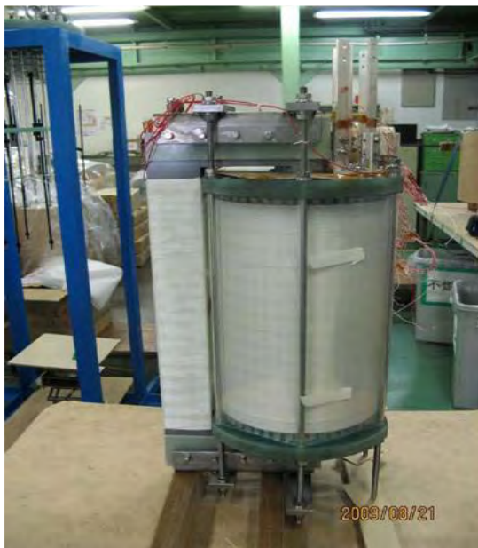
図 2.3.3-4 4巻線構造変圧器 (巻線、鉄心) の外観
