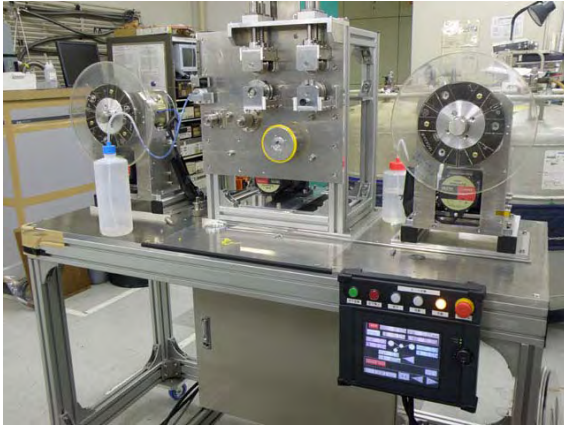
図 2.4.3-51 Reel to Reel マスクテープ 貼り合わせ機の外観
