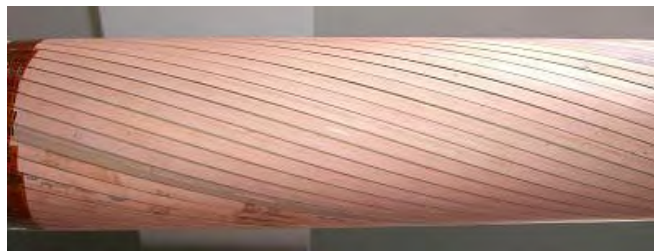
図 2.2.2-41 超電導導体 (上)、超電導シールド (下)
