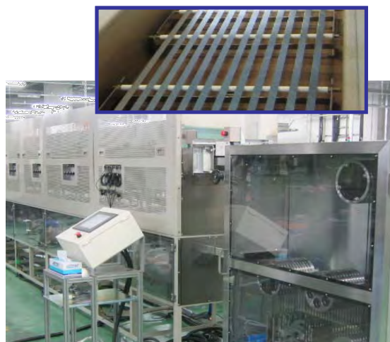
図 2.2.3-16 Reel-to-Reel 式連続塗布塗布仮焼炉の全景
