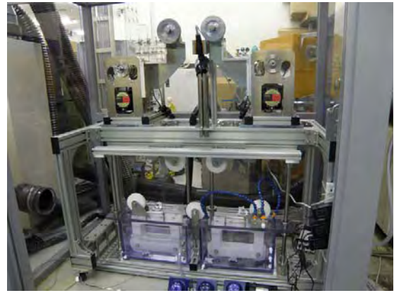
図 2.4.3-52 Reel to Reel エッチング 装置の外観
