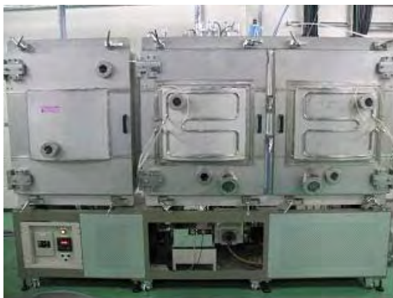
図 2.3.4-10 Reel-to-Reel 式連続高周波スパッタリング装置
