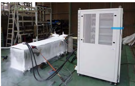
図 2.2.2-49 直流電源による I_c 測定
