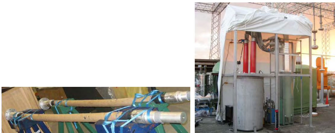
図 2.2.1-44 3500 mm 2 電流リードと熱損失測定試験
