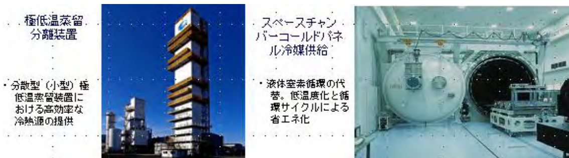
図 1.3.2-5 石油ガス・希ガスの極低温蒸留分離装置およびスペースチャンバーコールドパネル冷媒供給
