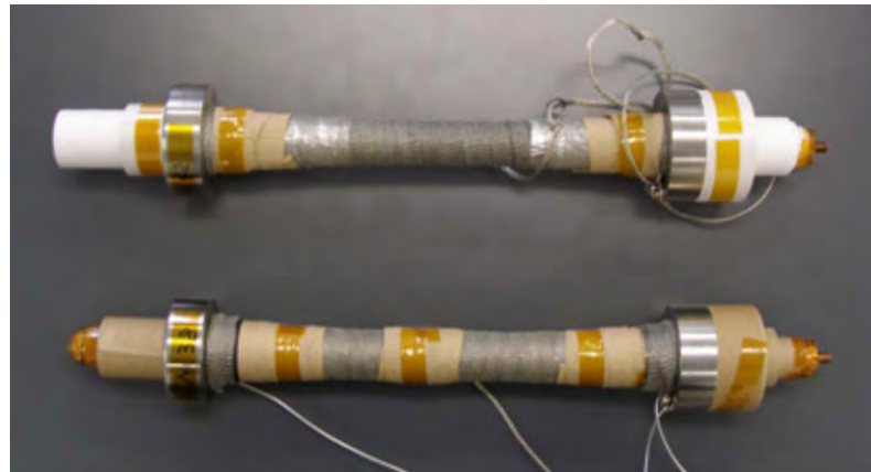
図 2.2.2-2 絶縁モデルケーブルの外観 (上が C 紙、下が B 紙)
