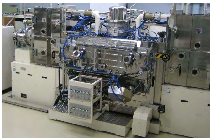
図 2.2.3-12 連続巻き取り式イオンビームアシスト蒸着装置
