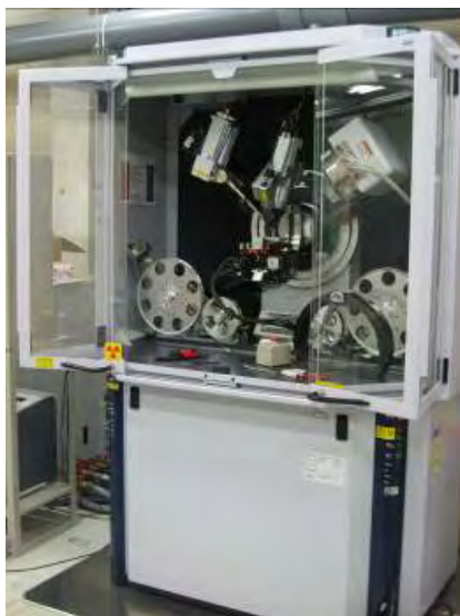
図 2.2.3-42 RTR-X 線回折装置 図 2.2.3-43 200 m 長の中間層（CeO 2 ）の面内結晶粒配向評価結果（5 m 間隔）
