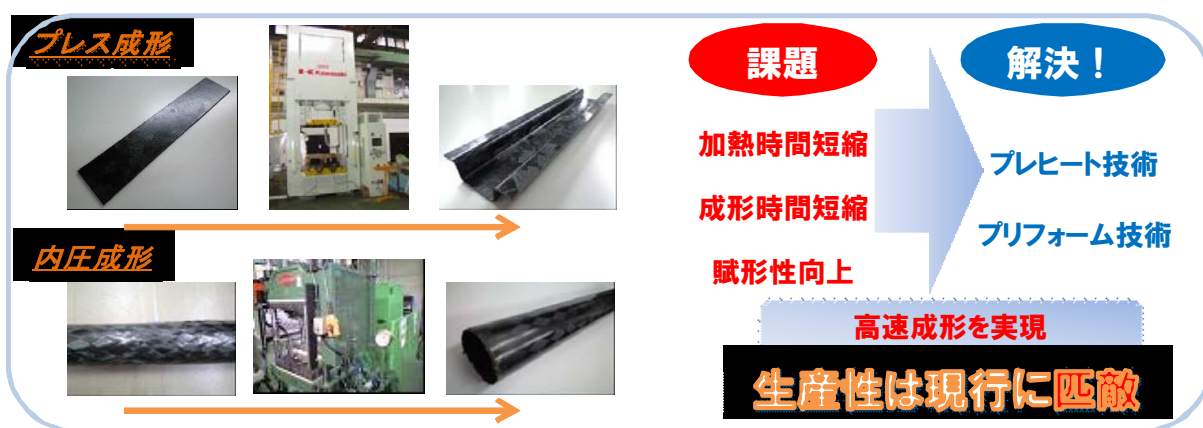
図Ⅲ-4 一方向性 CFRTP 中間基材の高速成形技術開発概要
