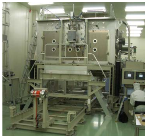
図Ⅲ-2.3B.1-2. 試作したG4蒸発源搭載G6チャンバ
