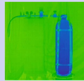
輻射熱による安全弁作動試験 水素放出時の附属品類の温度
