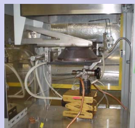
輻射熱による安全弁作動試験 水素放出時の附属品類の温度
