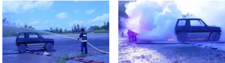
消火放水(放水量500L/min)の状況 消火剤(ABC消火器)の状況
