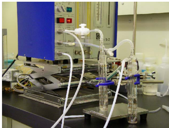
図Ⅲ 2.2.2.1-4 パーミエーターにより調製された定常濃度ギ酸ガスのインピンジャーによる捕集
