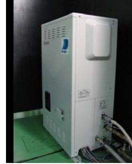
SOFCシステム
