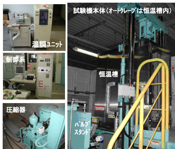
図 III 2.3(2)1-1 99MPa 級高圧水素ガス雰囲気下材料試験装置
