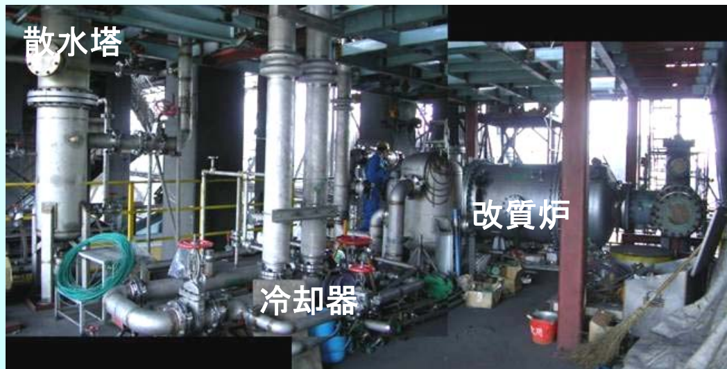
コークス炉建屋中間デッキ専用架台に据付完了した試験装置
