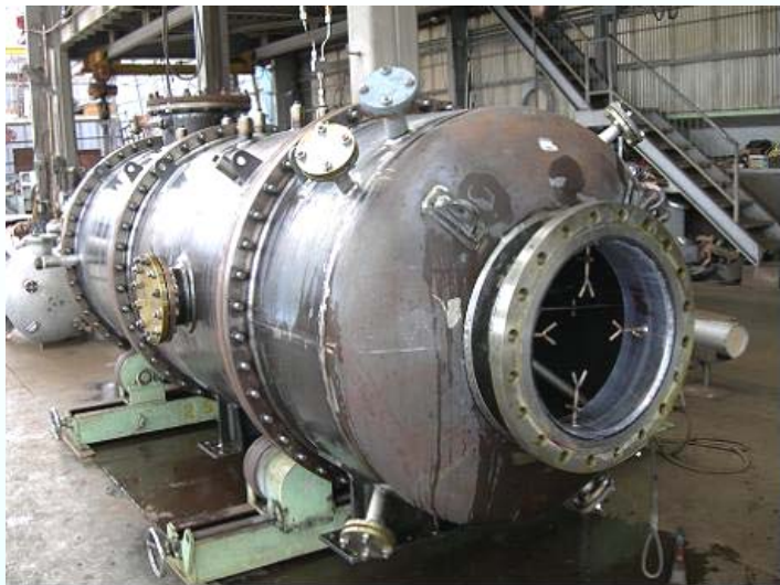
製作中の改質炉(外径φ1200mm×長さ4050mm)
