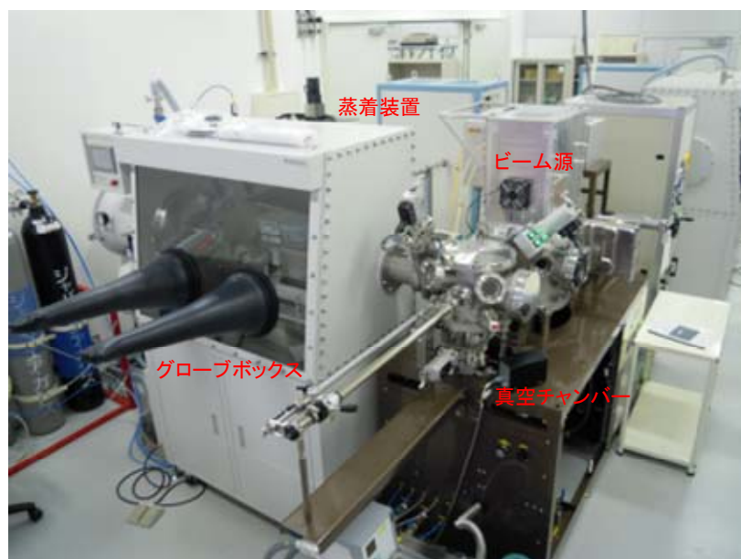
図②-(1)-1.51 設置完了後の装置全体
