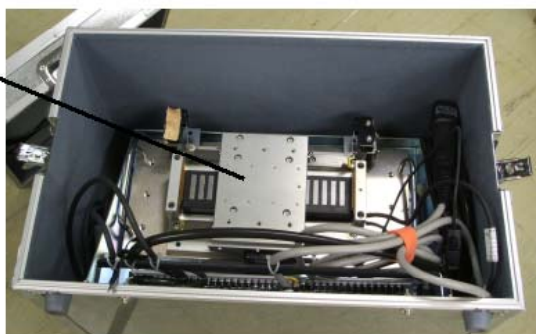
加振機とドライブアンプなど アルミ製コンテナで輸送可能
