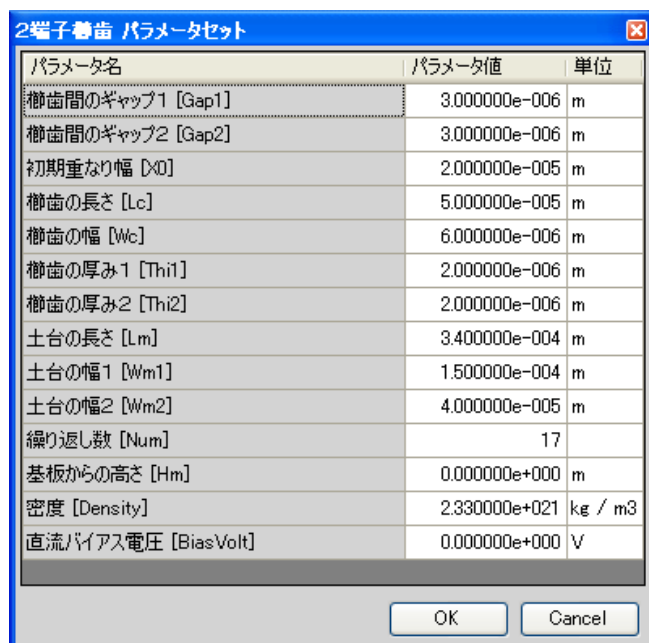
図⑤.6.2- 7 自動抽出された形状パラメータと材料物性パラメータ
