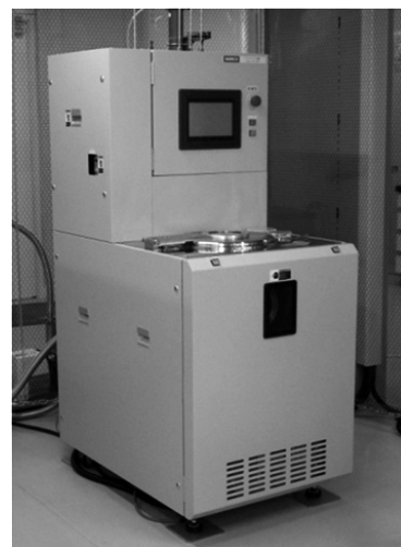
図①-62 ドライエッチング装置外観図 (サムコ株式会社:RIE-10NI)
