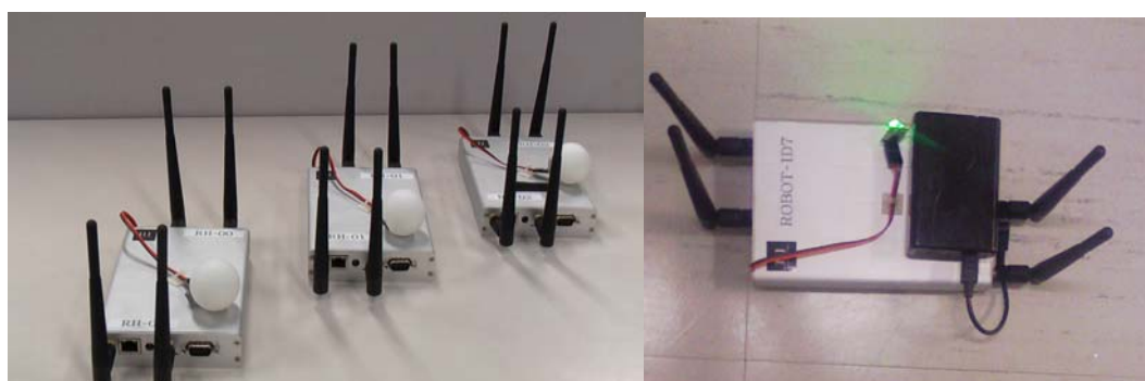
図 31: 第三世代ネットワーク構成ノードの外観 (左), バッテリー装着時 (右)
