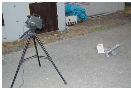
写真9 色彩輝度計実験状況
