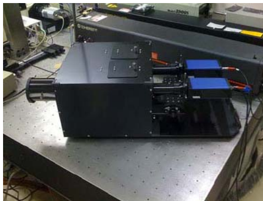
図Ⅲ-2-A5-6. インフライトメルティング挙動計測用装置
