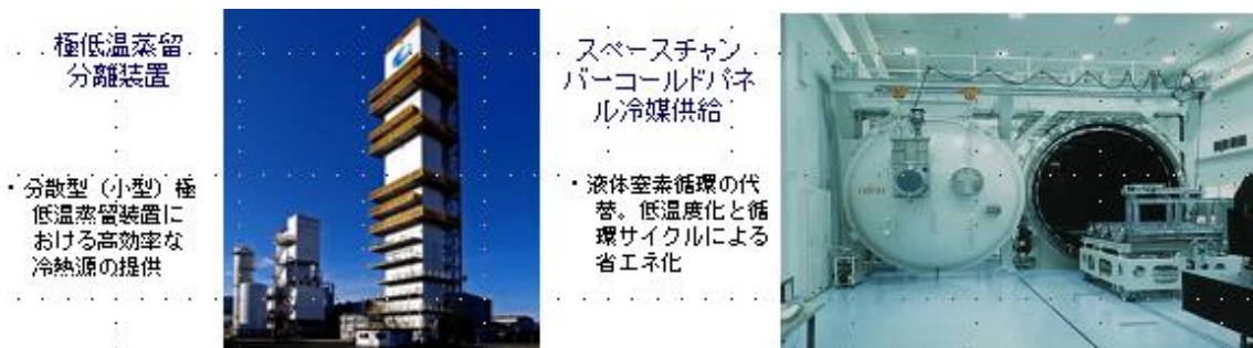
図 1.3.2-5 石油ガス・希ガスの極低温蒸留分離装置およびスペースシャトルコントロールパネル冷媒供給
