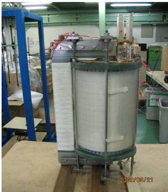
図 2.3.3-4 4巻線構造変圧器 (巻線、鉄心) の外観
