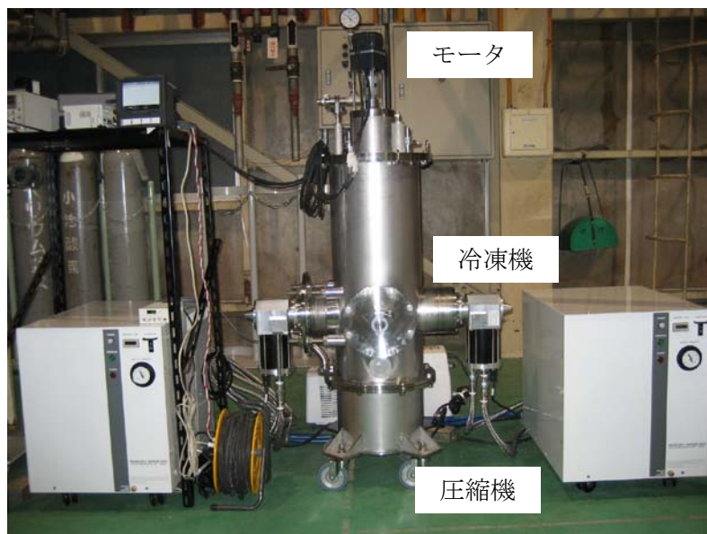
図 2.2.4-2 スラッシュ窒素生成装置の写真
