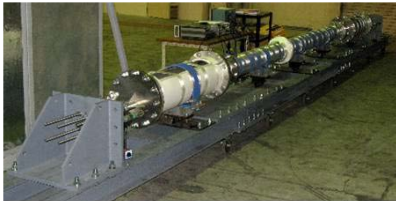
図 2.2.1-40 三心コア引張試験装置の概観写真
