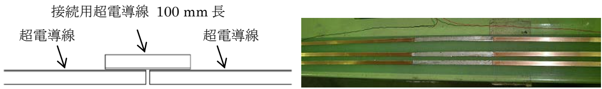
図2.2.2-51 5 mm幅Y系超電導線の接続
