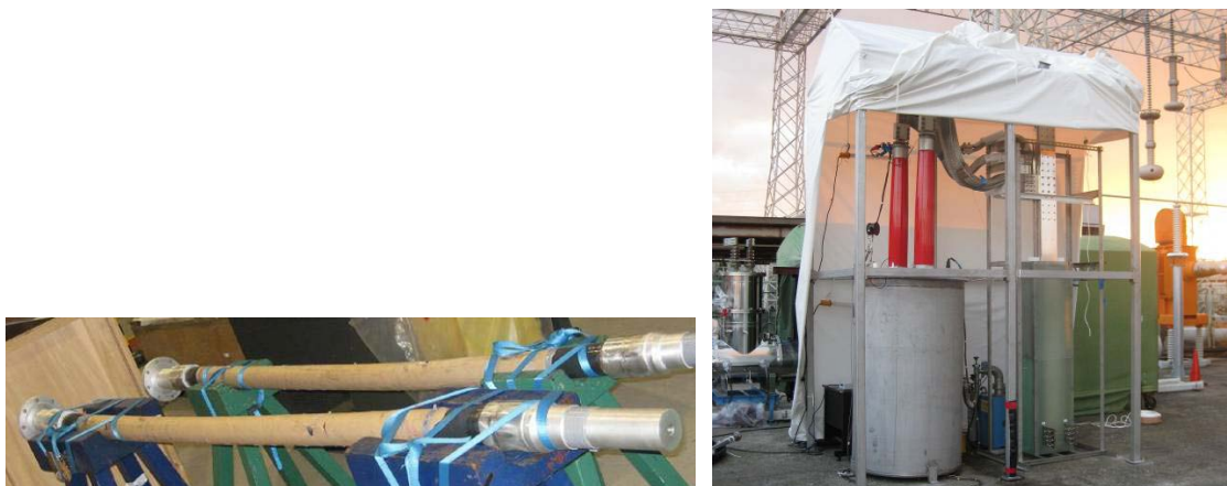
図 2.2.1-44 3500 mm 2 電流リードと熱損失測定試験
