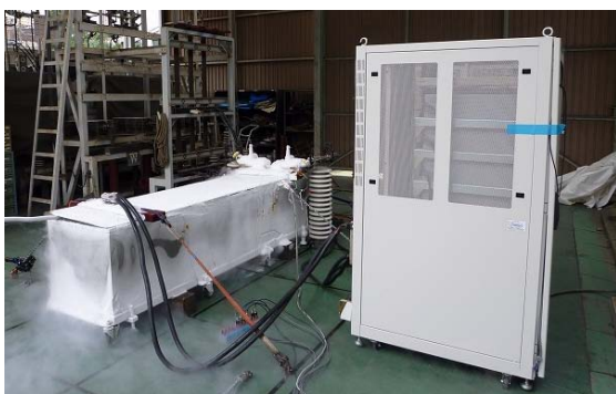
図 2.2.2-49 直流電源による I_c 測定
