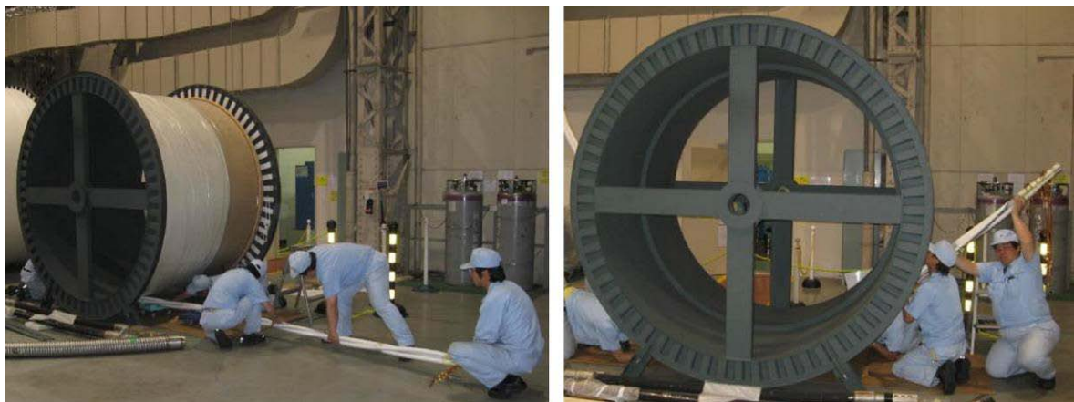
図 2.2.1-38 三心ケーブルコアの曲げ試験
