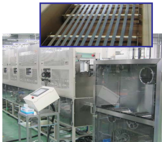
図 2.2.3-16 Reel-to-Reel 式連続塗布塗布仮焼炉の全景
