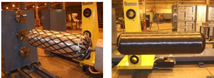
図 4 1530mm 容器試作状況
