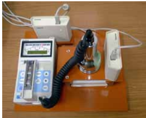
図 2.4-4 IC タグを用いた汚染検査装置への遠隔校正実験
