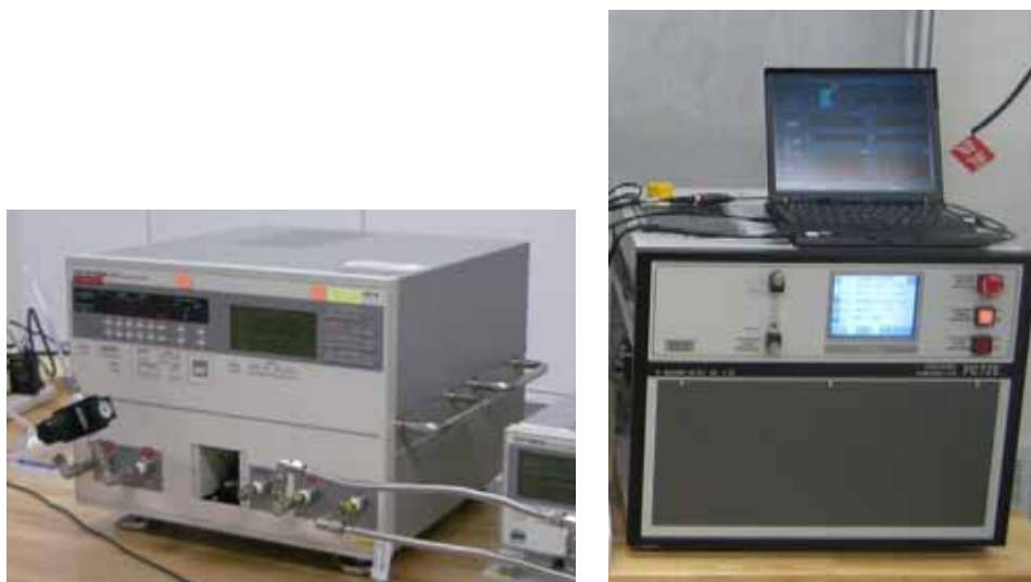
図 2.7-7 開発した H18 統合型仲介器。(左) 気体差圧用、(右) 液体圧力用
