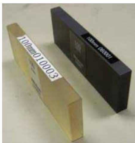
図 2.5-4 低熱膨張材料で作成された仲介標準器
