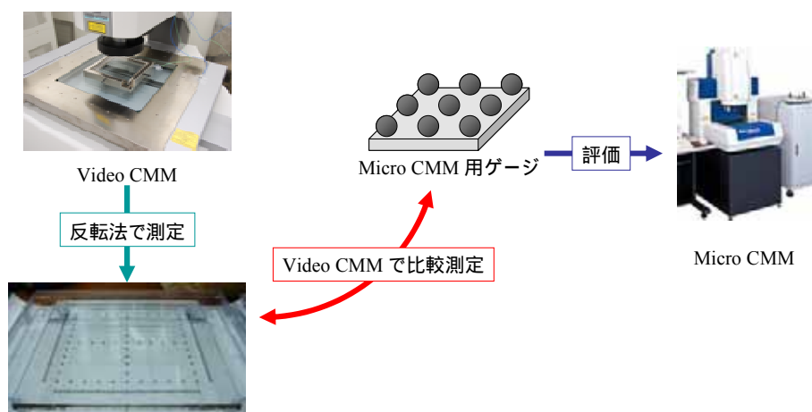
図 2.5-7 任意・微細形状用三次元測定機のための仲介標準器校正
