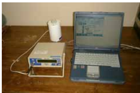
図 2.4-3 I-125 シード線源用線量測定装置の遠隔校正実験に用いた電離箱測定装置
