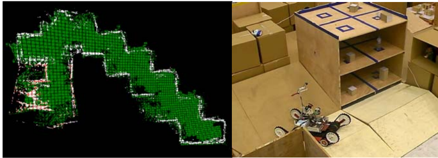
図 2 6 構築した 2 次元大域地図と対象環境 (RoboCup 2008 Suzhou)
