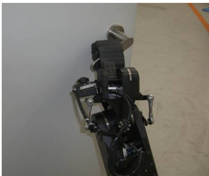
図 3 HELIOS-IX のアーム先端の関節機構
