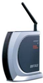
図 13 中継機能を実装したLinuxをインストールした市販のルータ
