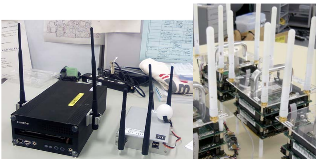
図 30: 第一世代と第三世代ネットワーク構成ノード (左), 第二世代ネットワーク構成ノード (右)
