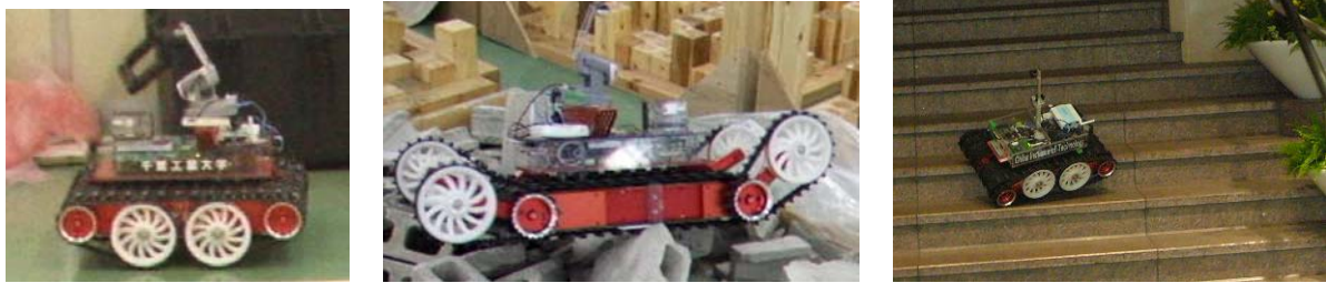
(a) 高速走行の姿勢 (b) 瓦礫上走行の姿勢 (c) 階段途上での信地旋回
