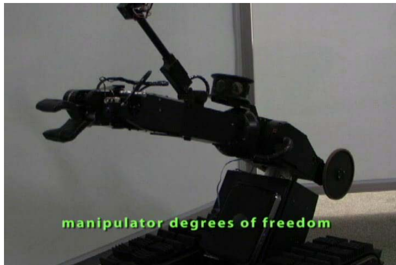
図 4 遠隔操作とハンドリング作業用の二つのカメラを備えたアーム機構
