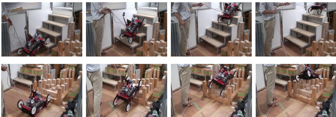
図 1 5 衝突判定に基づく半自律での階段，ランダムステップ踏破
