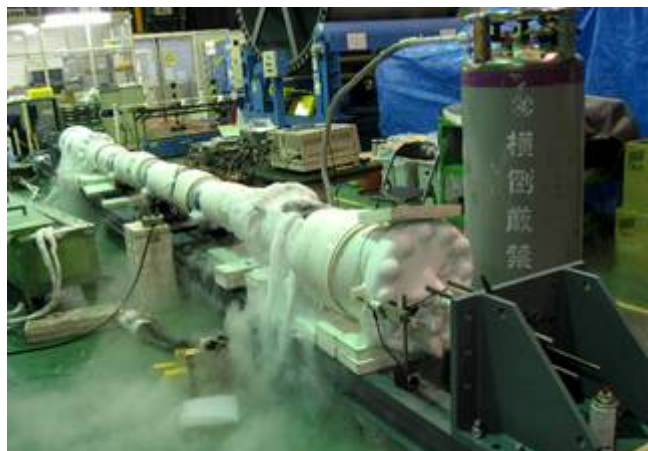
図 2.1.5-5 三心コアサンプルの LN2 中での引張試験状況
