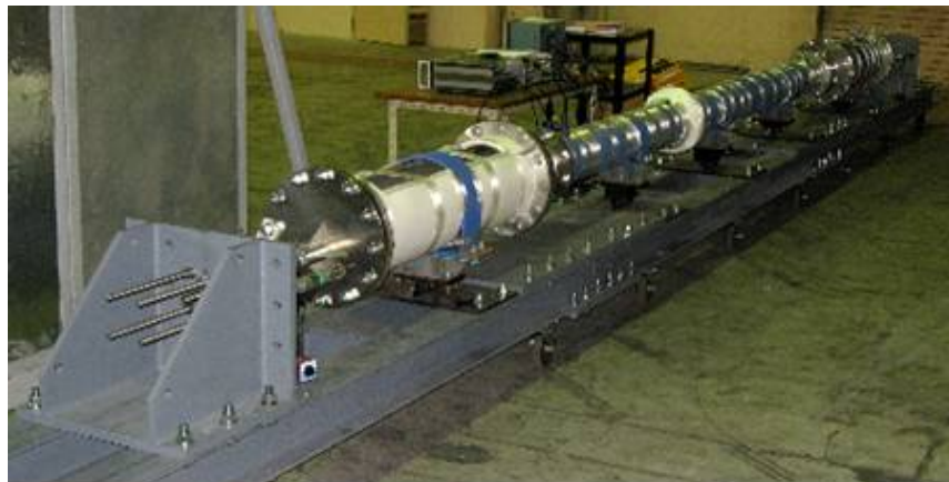
図 2.1.5-4 三心コア引張試験装置の概観写真
