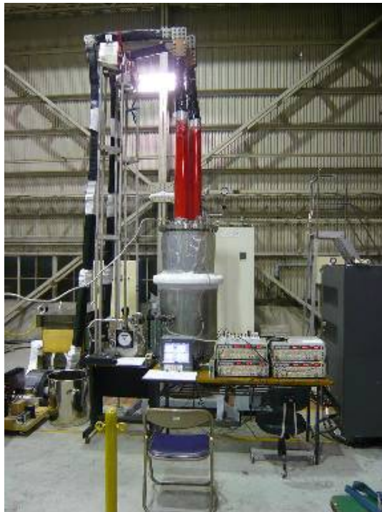
図 2.1.4-19 電流リード試験状況
