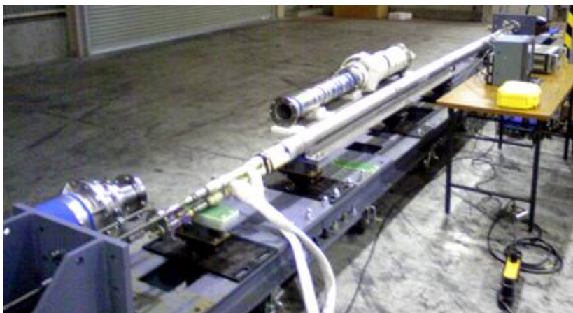
図 2.1.5-7 三心コア圧縮試験装置の概観写真
