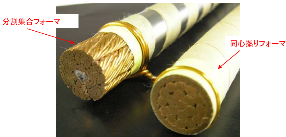
図 2.1.1-11 低損失型分割集合フォーマと従来の同心撚りフォーマ
