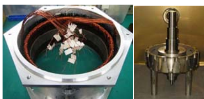
図3-46 試作機概観図 固定子(左)と回転子(右)
