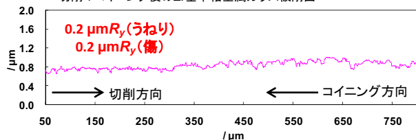
切削+コイニング後のZr基単相金属ガラス被削面の表面粗さプロファイル
