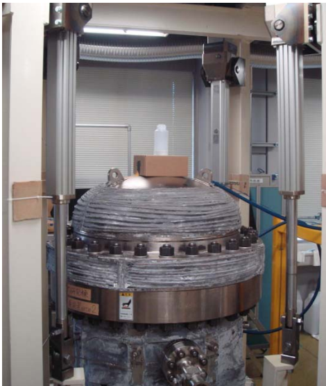
図5 4軸揺動機構付大型 GaN 結晶育成装置と揺動パターン
